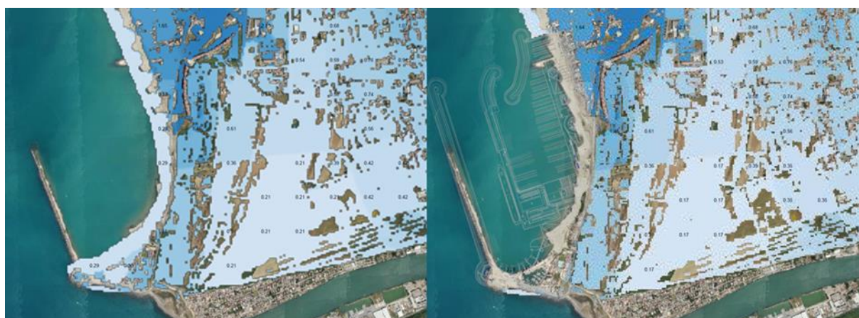
Figura 6.1.1. Confronto tra ante e post operam sull'area di progetto e limitrofe –Inviluppo delle massime elevazioni idriche; a sinistra, ante operam; a destra: post operam.
