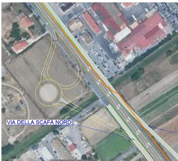
Figura 2.8: Ipotesi alternativa a Rampa diretta (non conforme a D.M. 2006)
