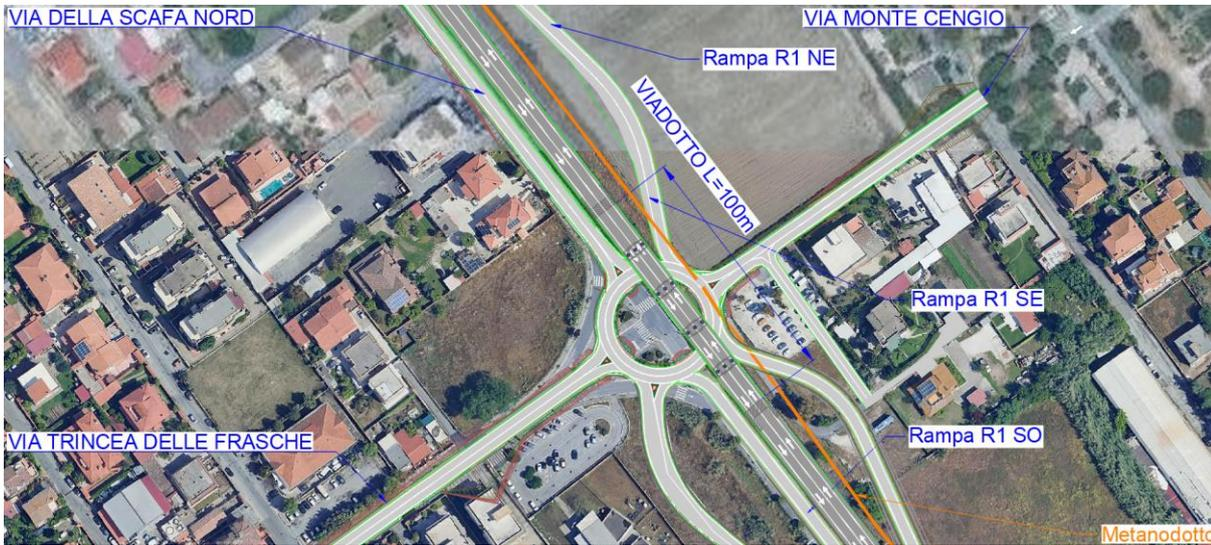
Figura 2.5: Progetto ANAS configurazione a livelli sfalsati dell'intersezione tra via dell'Aeroporto di Fiumicino (SS296), via della Scafa, via Trincea delle Frasche e via Monte Cengio
