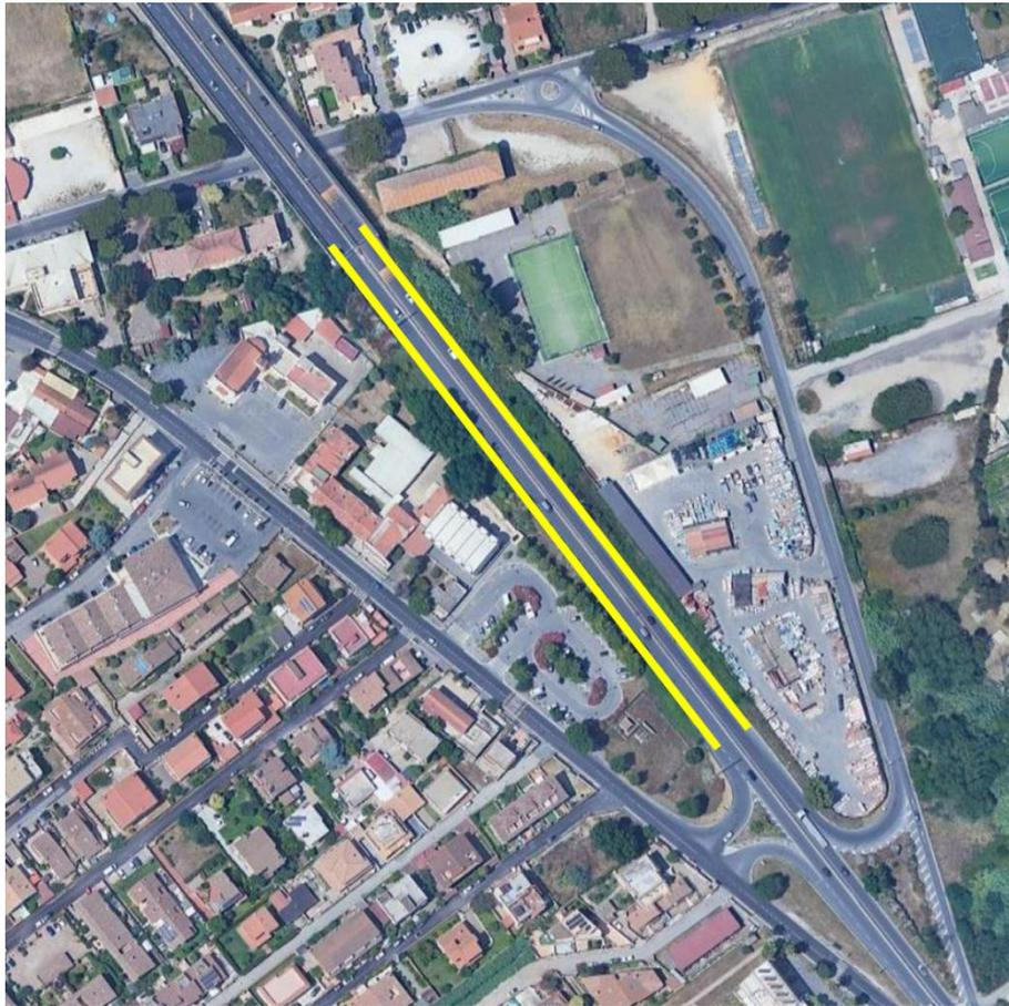
Figura 2.2: Proposta di inserimento di corsie di accelerazione in ingresso e decelerazione in uscita per lo svincolo della SS296 in corrispondenza di via della Scafa e via Santos Dumont
