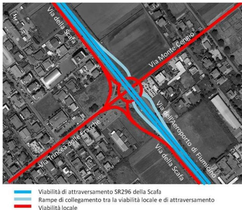
**Figura 3.59: Schema progettuale dello Svincolo a Livelli sfalsati per l'Intersezione tra Via dell'Aeroporto di Fiumicino e Via Trincea delle Frasche**
