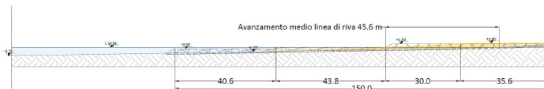
**Figura 3.40: Sezione trasversale tipologica dei pennelli**
